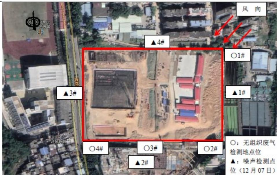
3-2 废气、噪声监测布点图（12月7日）
