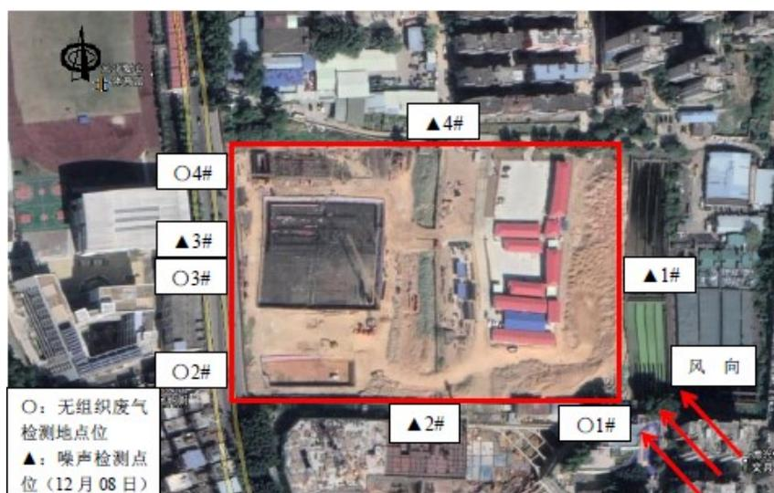
图 6-2 废气、噪声监测布点图（12 月 8 日）
