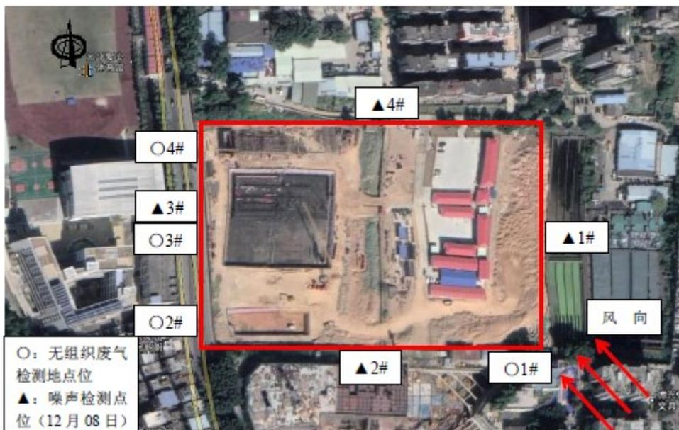
3-3 废气、噪声监测布点图（12月8日）
